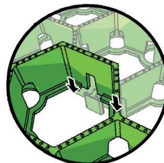
Système d'ancrage et de verrouillage intégré.
