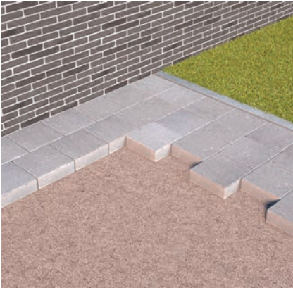
Plaatsing op stabilisatie in halfsteensverband en streklaag
