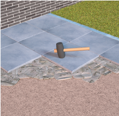
Placement dalles en mortier de pose sur stabilisé
