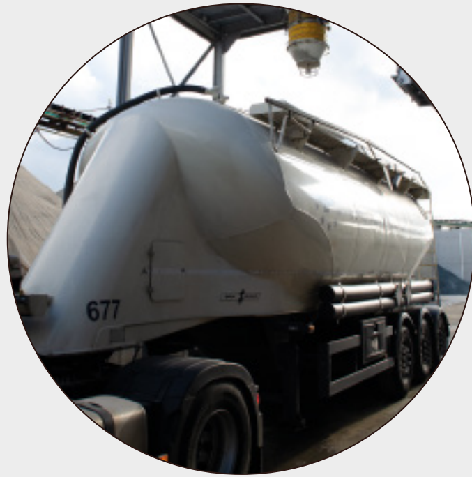
CAMION CITERNE POUR LE REMPLISSAGE DES SILOS
