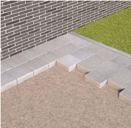
Plaatsing op stabilisatie in halfsteensverband en streklaag
