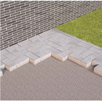
Plaatsing op stabilisatie in elleboogverband en strekklag
