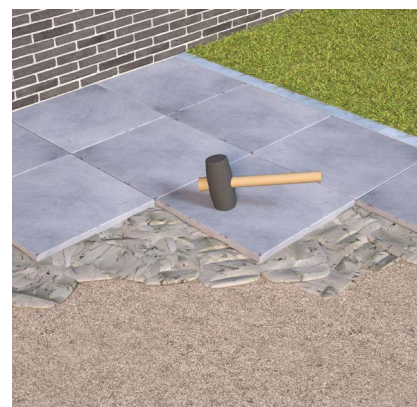
Plaatsing tegels in de legmortel op stabilisé
