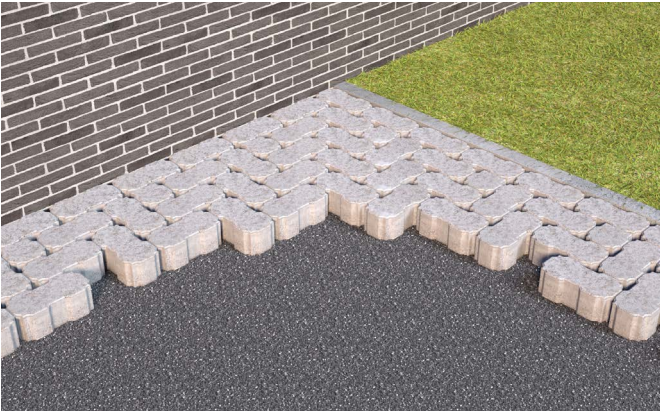
Plaatsing waterdoorlatende betonstraatstenen op split in verband met strekklaag
