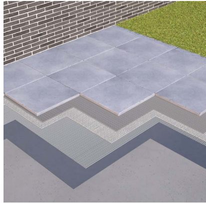
Plaatsing met drainagemat op betonplaat
