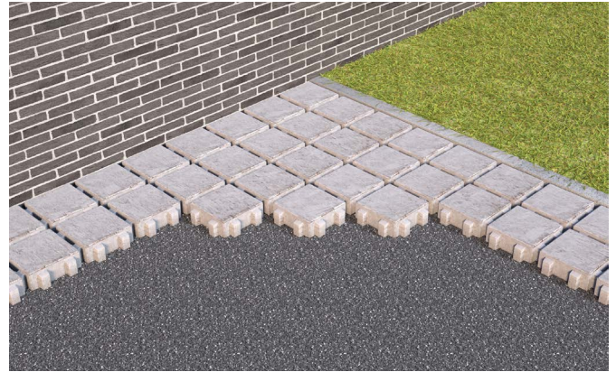
Plaatsing waterdoorlatende klinkers op split in verband met strekklaag
