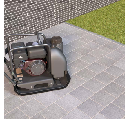
Aftrillen met trilplaat voorzien van rubberen zool
