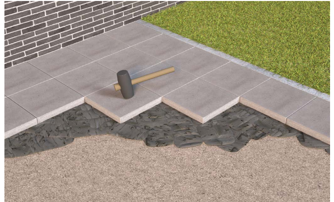
Plaatsing tegels aankloppen met rubberen hamer
