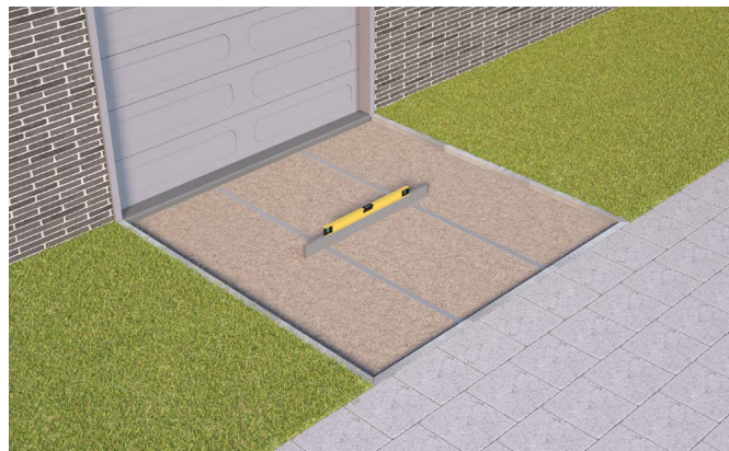
Fondation, lit de pose, nivellement avec des lattes et des règles en alu et lattes d'alignement
