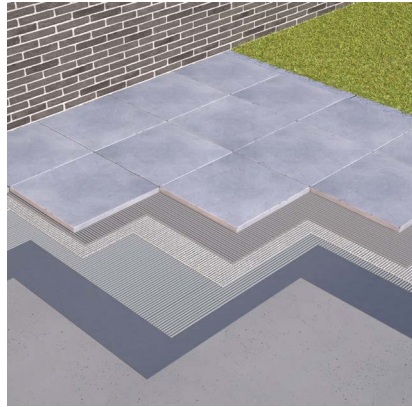
Placement avec une natte de drainage sur dalle de béton
