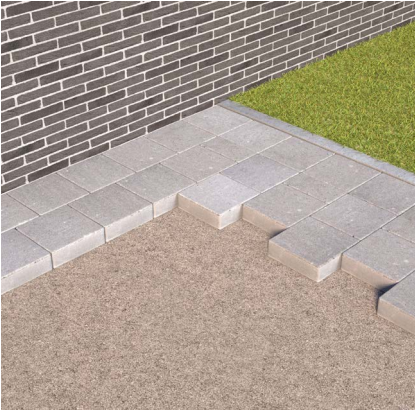
Placement sur stabilisé en appareil à mi-brique
