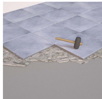
Placement de dalles en mortier de pose
