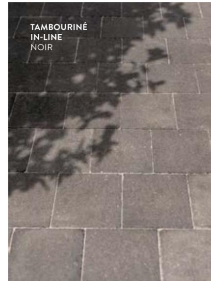
La technique du tambourinage in-line consiste le traitement de la surface du pavé avec des fins marteaux. La finition est alors plus fine, moins rugueuse que lors d'un tambourinage cylindre. Un autre avantage du tambourinage in-line est que tous les pavés sont posés sur la palette face visible vers le haut. De
